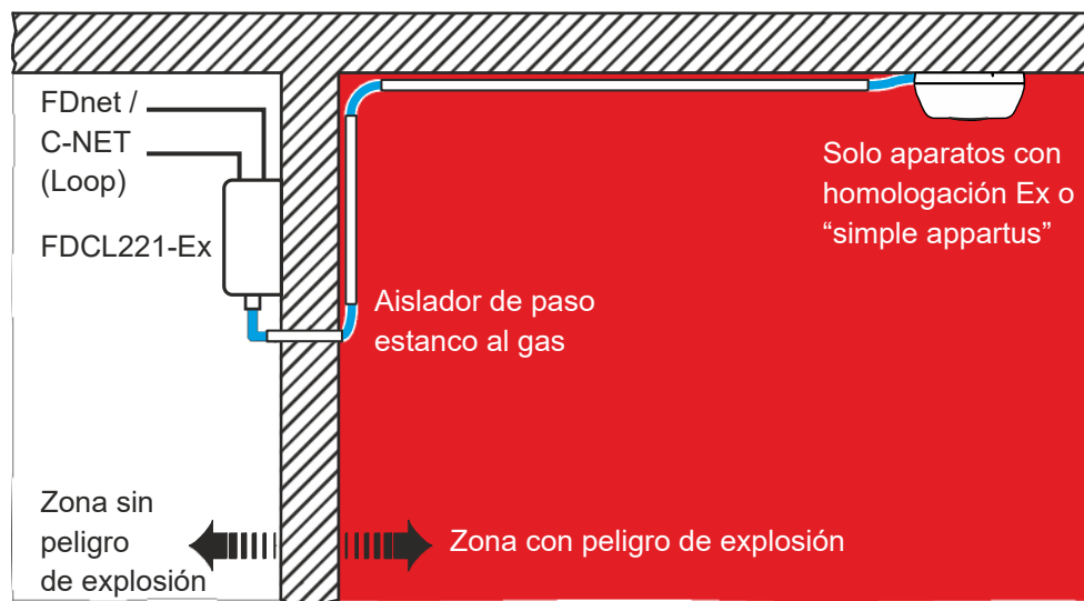
Fig. 5: Ejemplo de una instalación en una zona con riesgo de explosión
