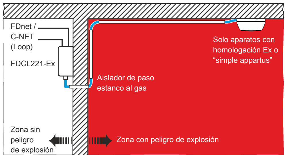
Figura 5: Ejemplo de una instalación en una zona con riesgo de explosión
