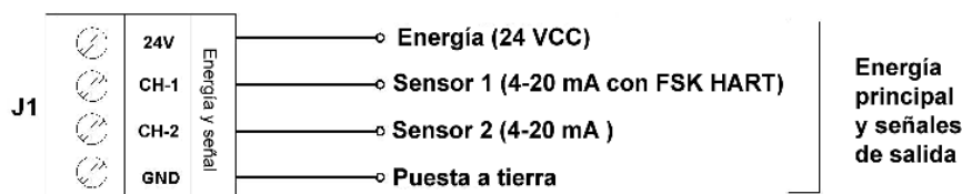
Figura A - 6 Conector J1 de energía y señal en monitor iTRANS-2 que admite HART
