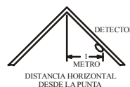
Figura 5: LUGARES RECOMENDADOS PARA INSTALAR DETECTORES DE HUMOS EN HABITACIONES CON TECHOS INCLINADOS, EN PICO O A DOS AGUAS
