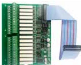
Módulo de expansión para añadir otros 16 relés y así configurar diferentes tipos de maniobras.
