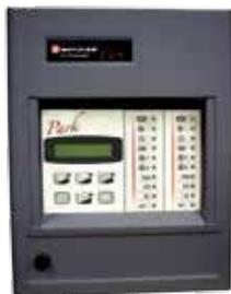
Central de detección de monóxido de carbono de 1 zona ampliable a 2 zonas. Cabina compacta que incluye 1 módulo de control, 1 módulo P-100, fuente de alimentación y entrada para tensión de emergencia de 24 Vcc.
