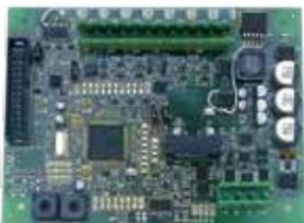
Módulo interfaz de 8 entradas de 4-20mA (8 sensores "SMART 3") para conectar al bus RS485 de las centrales MULTISCAN++. Requiere caja para montaje G-BOX o similar y alimentación externa de 12 a 24 Vcc.
