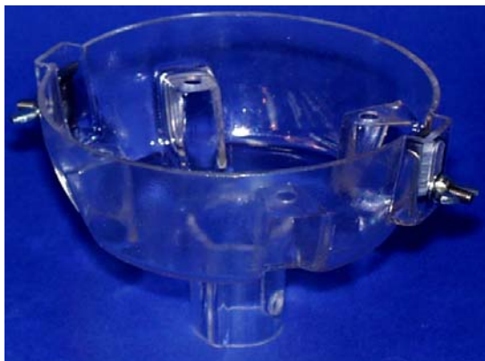
Fig. 12: Herramienta de desmontaje de detectores
