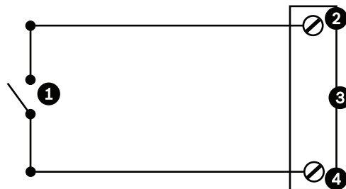
Figura 10.4: N.O. - Collegamenti non supervisionati normalmente aperti
