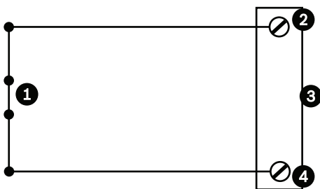
Figura 10.5: N.C. - Collegamenti non supervisionati normalmente chiusi
