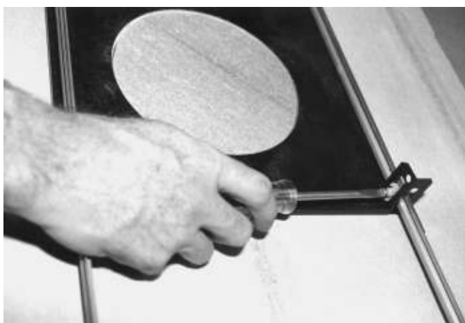
Figura 7.3: Serraggio della vite di sicurezza staffa
