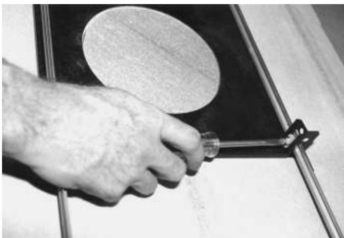
Рис. 9.3: Затягивание крепежных винтов кронштейна
