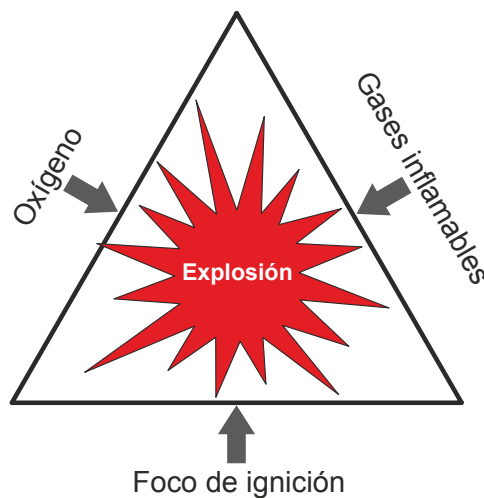
Figura 1: Triángulo de explosión
