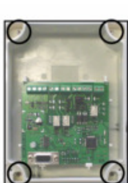
Fig 2: Distancia entre orificios y Ø máximo de tornillo
