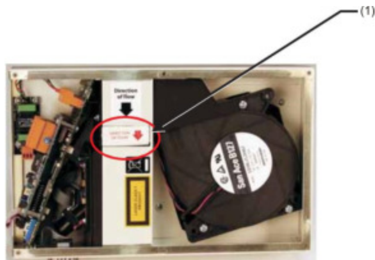
(1) Cartucho del separador de polvo (filtro)
