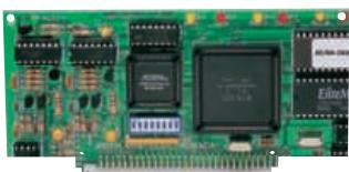
Unidad de control microprocesada de dos bucles analógicos fabricada por AGUILERA ELECTRÓNICA. La capacidad de cada bucle es de 125 equipos, al que se conectan los detectores, pulsadores, módulos de maniobras, de control y demás elementos que configuran la instalación. Capacidad de control total de 250 equipos.
