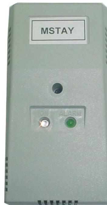
Este módulo dispone de salida para la activación de un piloto remoto, que se activa cuando está en estado de alarma. El Módulo de Señales Técnicas se alimenta por la conexión al bucle.
