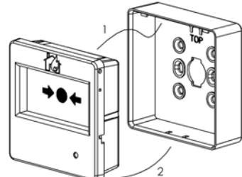
Una vez conectados los cables, volver a montar el frontal del pulsador introduciéndolo en la caja, primero la parte superior inclinándolo y haciendo coincidir las pestañas, y después presionando ligeramente en la parte inferior.
