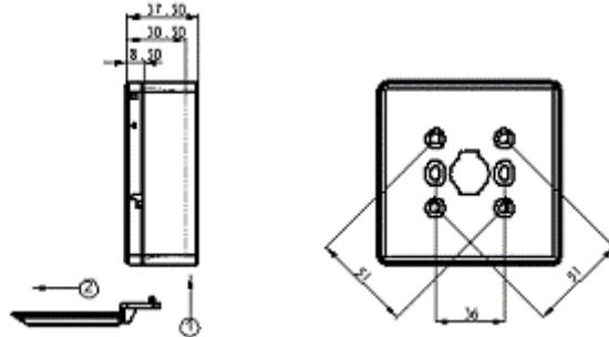
Para su instalación, fijar la caja del pulsador a la pared mediante 2 tornillos utilizando los orificios de sujeción previstos para tal fin, introduciendo los cables de conexión por el orificio situado en la parte central de la caja.
